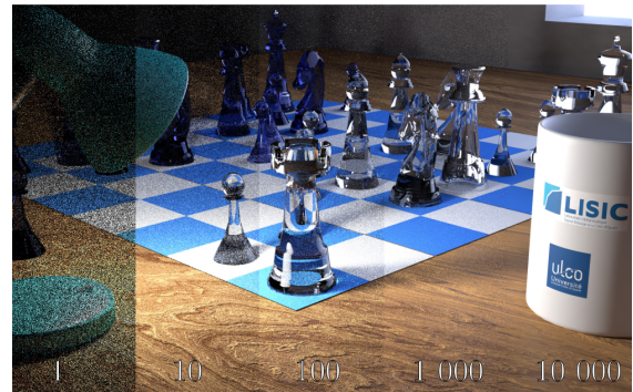
FIGURE 1 – Image rendue par tracé de chemins avec un nombre croissant de chemins par pixel (de 1 à 10 000). Le bruit est très important avec un nombre faible de chemins et décroît avec l'augmentation de ceux-ci.
